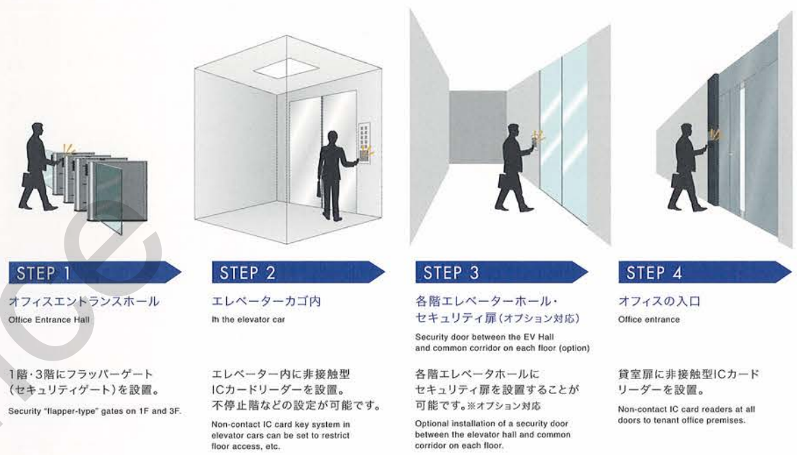
セキュリティ概念図 Conceptual diagram of 4 layers of security
