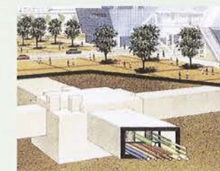
共同溝システムの イメージ図
