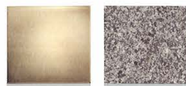
意匠柱 カラーステンレス(ブロンズ色) 壁面 花崗岩タイル
